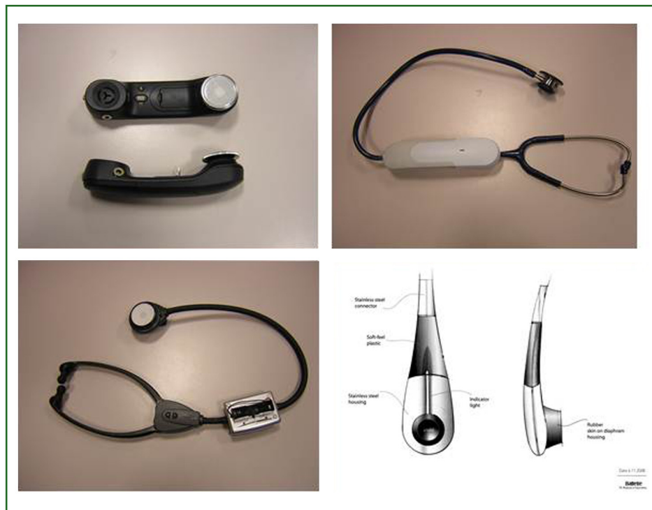
Figure 1. Several prototypes of the digital stethoscope that we developed. Différents prototypes du stéthoscope électronique que nous avons développés.
