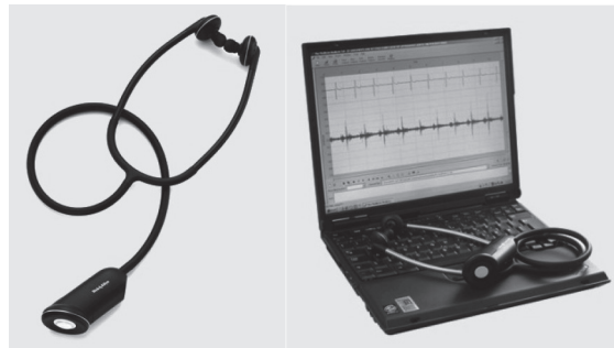
Figure 20 : Stéthoscope l' Elite™ Electronic Stethoscope de Welch Allyn avec le logiciel de visualisation des sons sous forme de cardio-phonogramme, ce dernier étant synchronisé avec un signal ECG [24].
