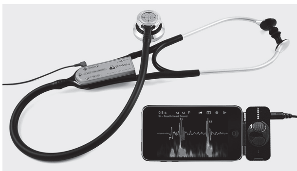
Figure 18 : Stéthoscope de chez Thinklabs avec son logiciel de visualisation [21].
