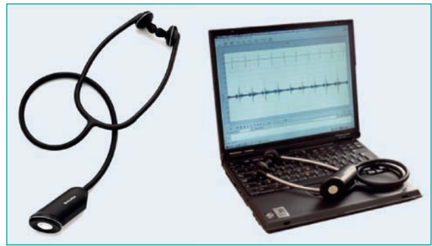
Figure 21. Stéthoscope l'Elite™ Electronic Stethoscope de Welch Allyn avec le logiciel de visualisation des sons sous forme de cardio-phonogramme, ce dernier étant synchronisé avec un signal ECG [24].
