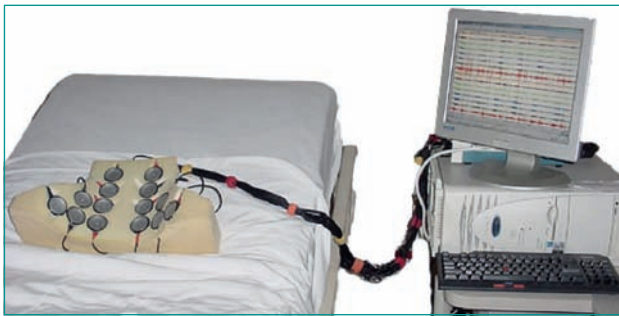
Figure 16. Système de capture des sons, développé par Stethographics, sous forme de coussin équipé de microphones permettant de capter simultanément les sons pulmonaires ou cardiaques, en différents points sur la face postérieure du thorax [20].
