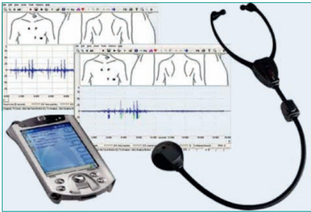
Figure 3. Stéthoscope électronique Androscope i-stethosMC et module d'enseignement Androscope [7, 8].
