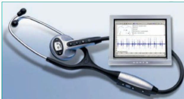
Figure 14. Stéthoscope électronique 3M Littmann Electronic Stethoscope Model 4100WS, avec visualisation du signal acoustique sous forme de cardio-phonogramme, dans un 2 e temps, après transmission à un PC [16].
